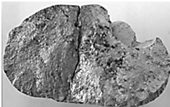
Рис. 1. Строение излома слитка сплавов NiAl с добавками Zr
