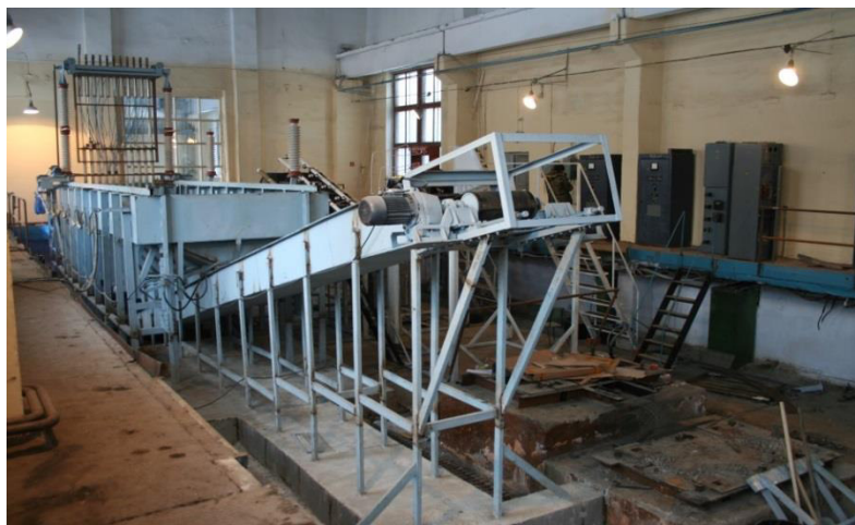
Электроразрядная установка для утилизации ЖБИ
